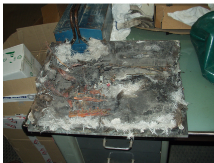
FIGURA 9.11: Efectos del funcionamiento de un diseño defectuoso de una caja de protecciones que incluye varistores.
